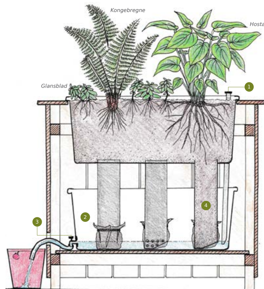
Principsnit af plantekasse med eksternt reservoir.
